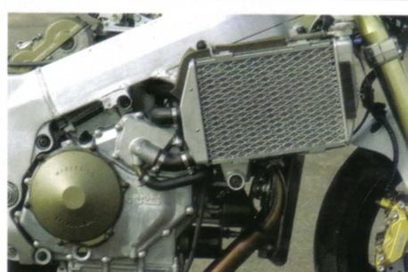
DÉSORMAIS, UN PETIT VENTILATEUR ASSURE LE REFROIDISSEMENT NÉCESSAIRE DU RADIATEUR LORS DES ARRÊTS STOP & GO.
